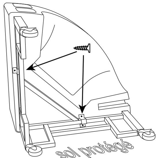
7) Fixation pour la hauteur **75 cm** : insérer le socle directement sous le bac, en fixant les pattes de fixation.
