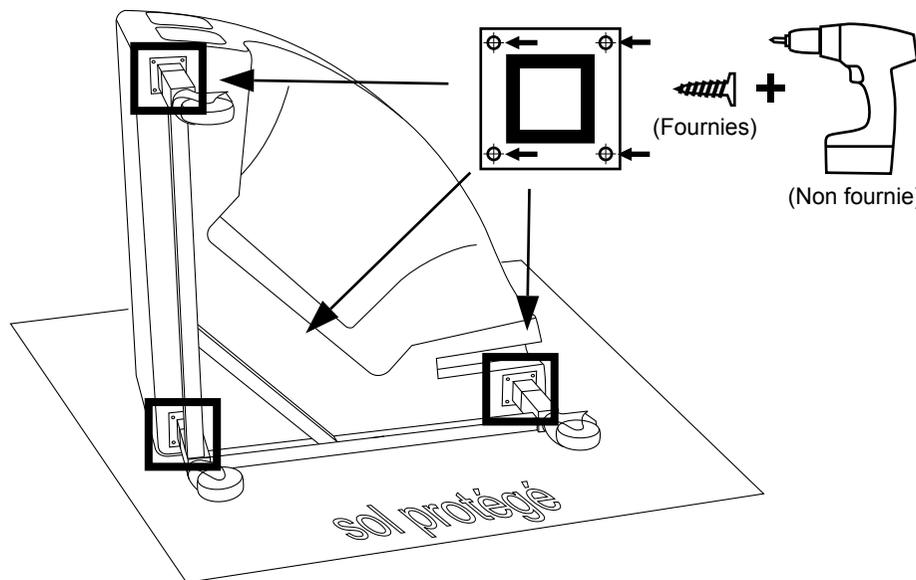
5) Fixation : visser l'extension du pied sur le bac (avec visseuse si possible).
