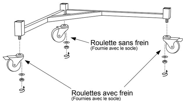
1) Installer les 3 roulettes : fixer avec une clé à molette dont la taille d'ouverture est 17.
