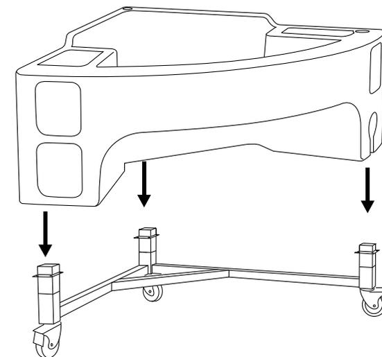
3) Installer le bac en faisant entrer les 3 embouts des extensions dans les trous correspondants sous le bac.
