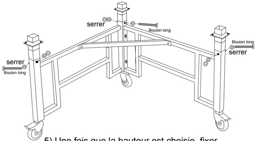
5) Une fois que la hauteur est choisie, fixer définitivement le bouton avec l'écrou (assemblage de l'étape 2). Fixer ensuite les extensions avec le socle (pour hauteur **80 cm, 85 cm et 90 cm**).
