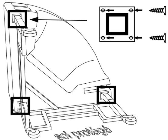
7) Fixation : visser l'extension du pied sur le bac. Il est fortement déconseillé de dévisser les vis pour changer la hauteur après l'installation.
