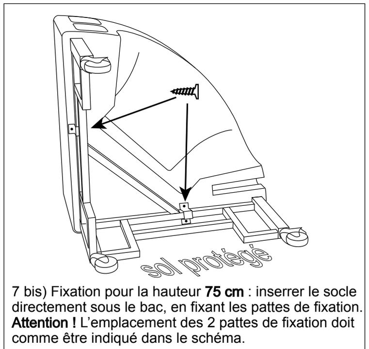
7 bis) Fixation pour la hauteur **75 cm** : insérer le socle directement sous le bac, en fixant les pattes de fixation.
