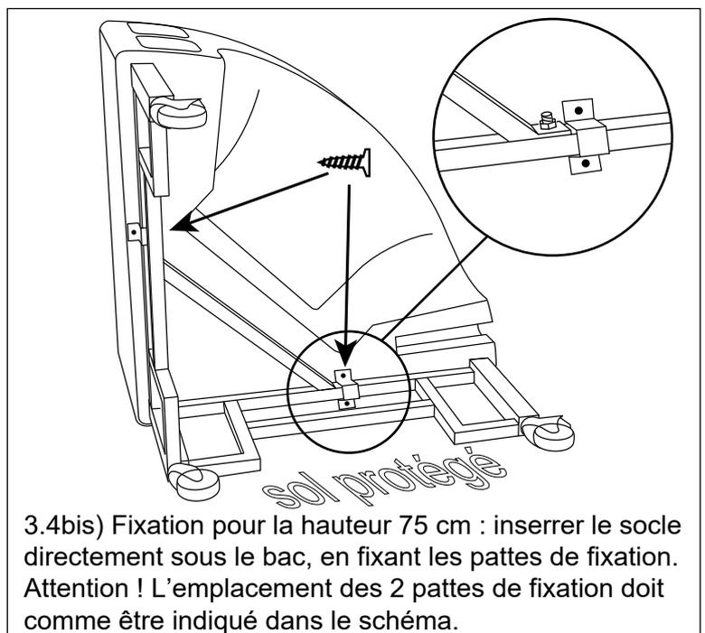
3.4bis) Fixation pour la hauteur 75 cm : insérer le socle directement sous le bac, en fixant les pattes de fixation.
