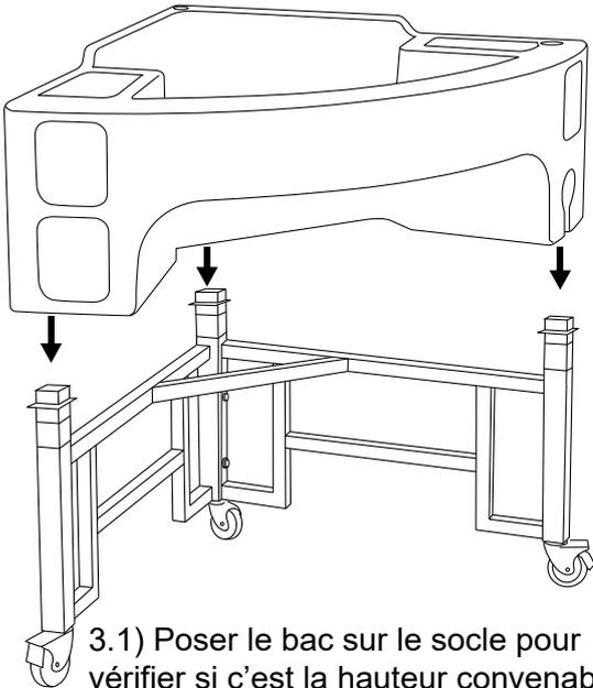
3.1) Poser le bac sur le socle pour vérifier si c'est la hauteur convenable.
